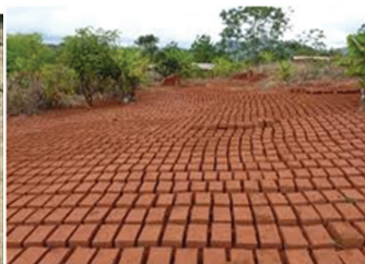
හැඩගැන්වීම කර ඇති ගඩොල් වියළීමට තබා ඇති අයුරු
